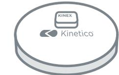
UTILIZANDO TORNILLOS, ARANDELAS Y ESPACIADORES DE NIVELACIÓN, FIJE EL CUERPO DEL MONITOR DE SAL A LA PARTE SUPERIOR DE LA TAPA DEL TAMBOR DE SAL (SE MUESTRA LA COLOCACIÓN APROXIMADA).
