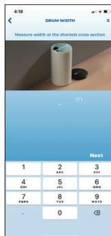
e. Si se selecciona el cilindro, mida el ancho del tambor de sal e ingrese las medidas en pulgadas en la aplicación. Redondee a las 0.25 pulgadas más cercanas. Presione "Next" (Siguiente).
